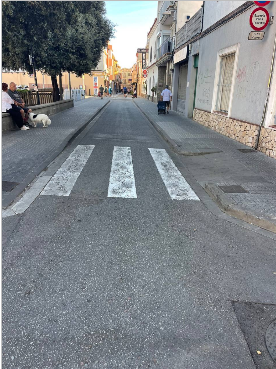
Fotografía nº 1. Cartel de excepción «Excepte veïns i serveis», con placa complementaria «En tot el carrer», colocado sobre el paramento de fachada en esquina y a una altura muy superior a la de circulación. En el mismo paramento se aprecia el resto de la señalización vertical existente en el tramo.
